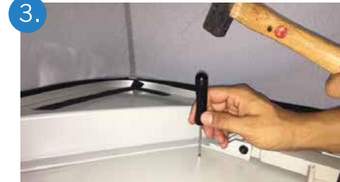
3. Marquer les emplacements des trous avec un pointeau.
