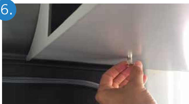
6. Visser la pièce femelle et serrer pour laisser le meuble fixe.
