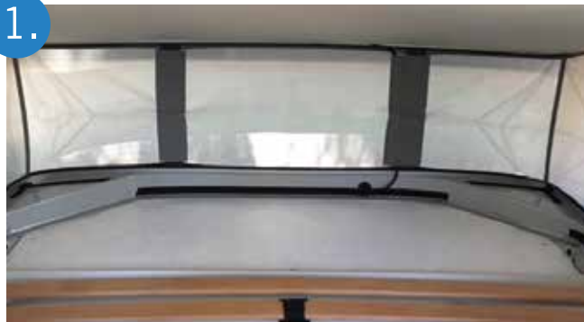
1. Enlever le matelas arrière et présenter le gabarit de perçage.
